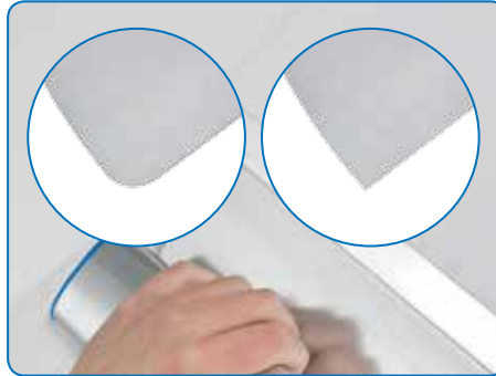
0,3 mm Blatt mit runden Ecken für glattes Abziehen und wenig Nacharbeit 0,5 mm Blatt mit geraden Ecken zum scharfkantigen Nachziehen von z. B. Kalk-Zement- und Armierputzen
